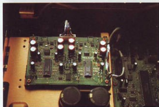
Apart opgestelde print met 2 TDA-1547 converter chips
